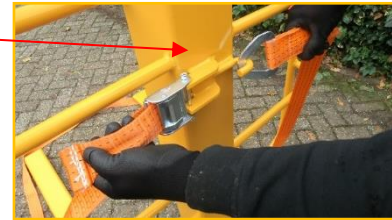
afb. 5: correcte montage bandbeveiliging
