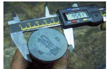
Controle maatvoering kogelkoptransportankers
